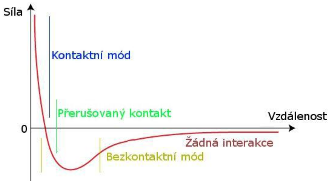
Obr. 12 Závislost síly interakce na vzdálenosti hrotu od vzorku
