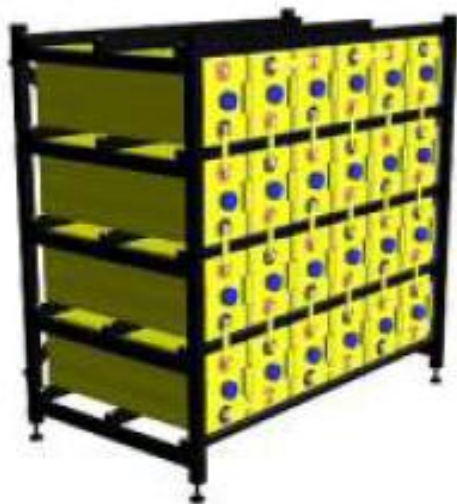
Obr. 5.: Novinka fy. SEC (USA) – model 2TLGM -VRLA akumulátor deskové konstrukce s AGM separátorem s možností horizontálního i vertikálního uložení. Kromě kyslíkového cyklu je umístěn ve ventilu katalyzátor-minimalizace vývinu plynů a koroze záporné elektrody
