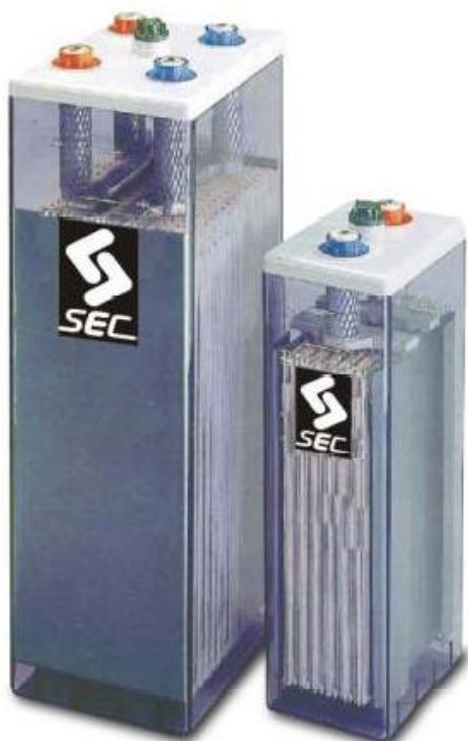
Obr.4: Olověný akumulátor zaplavené konstrukce fy SEC (USA), model SEC-T-RANGE, kladná elektroda trubková, záporná elektroda desková pastovaná
